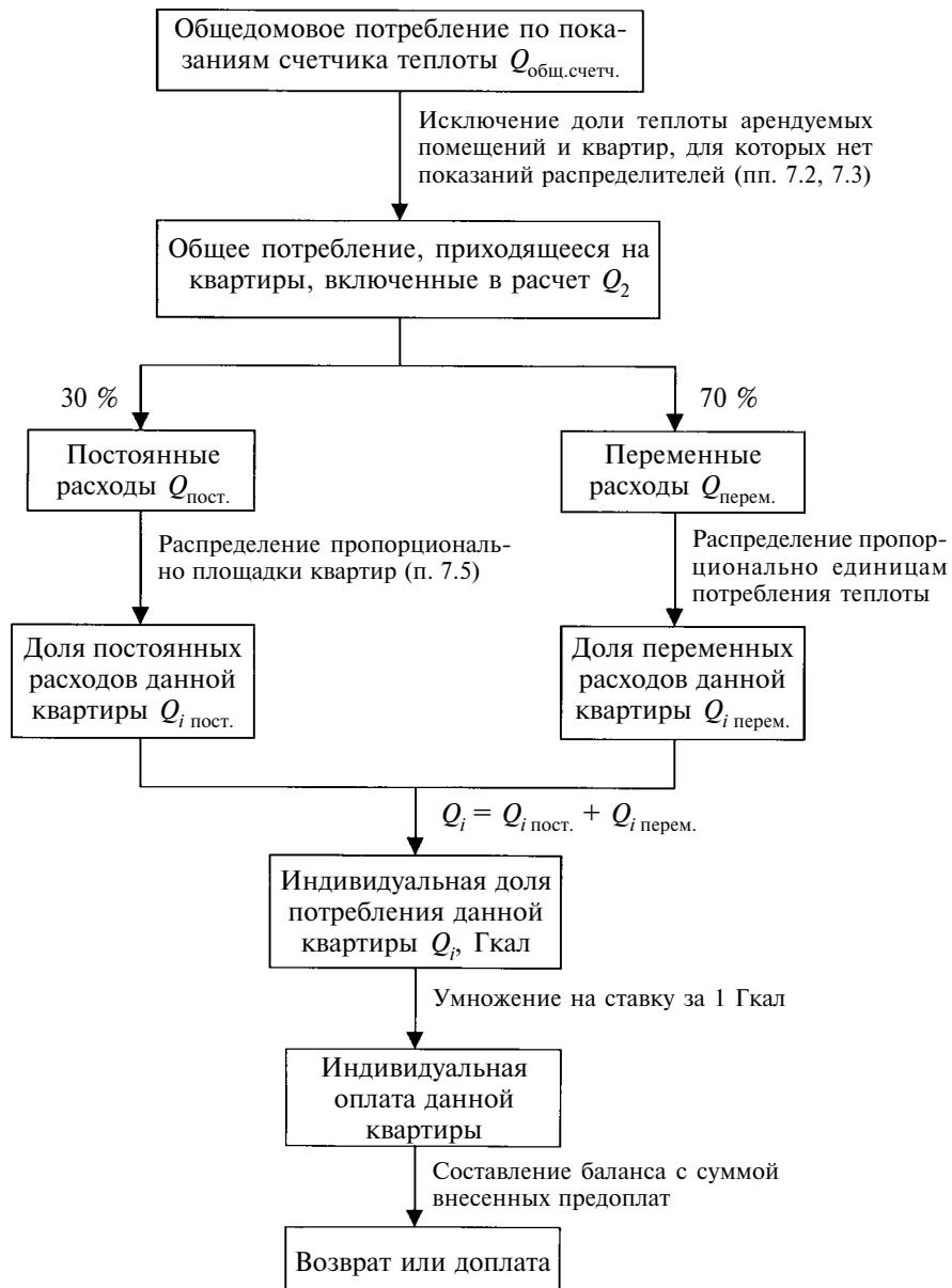
Рис.1. Обобщенная схема распределения общедомовых затрат тепловой энергии
